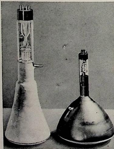
Bild 63. Ansicht einer älteren und einer modernen Fernsehrohr
