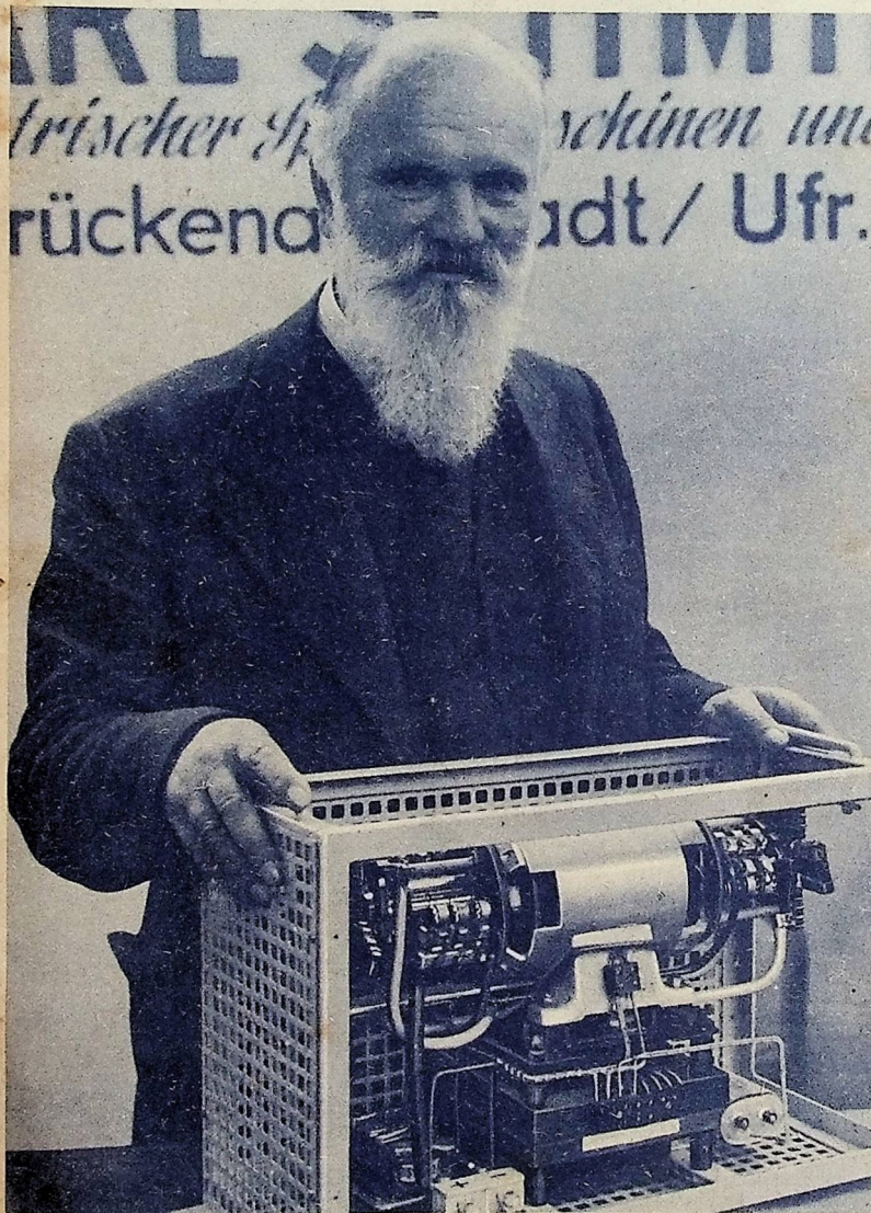
Auf der Münchener Elektromesse zeigte Dr. Ing. Karl Schmidt, der früher bei der C. Lorenz AG. Hochfrequenz-Maschinensender und Spezialmaschinen baute und zu den Pionieren des Maschinensenders gehört, diesen Gleichstrom-Wechselstrom-Umformer. Für die Herstellung der Wechselspannung wird eine rotierende mit Kollektoren und Schleifringen zusammengebaute Widerstandsordnung benutzt.
