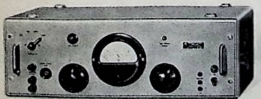
Bild 3. Direkt zeigendes Klirrfaktormeßgerät für 4 Meßfrequenzen (Typ FTZ)
