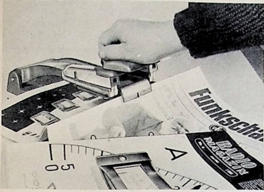
Der Ringösen-Heftapparat, großes Modell, im Gebrauch Aufnahme: C. Stumpf
