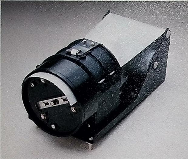
Eine technische Sensation ist der in das **TA 80** Terminal eingebaute Hochleistungsdrucker mit neuartigem Druckverfahren. Buchstaben, Ziffern, Diagramme und Zeichnungen werden blitzschnell ausgedruckt.
