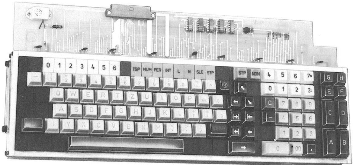
Die Tastatur, Ger. Nr. 1, ist eine Eingabeeinheit für den Processor. Sie besteht aus:
