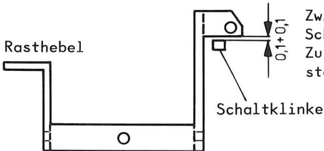
Zwischen Rasthebel und der Schaltklinke muß im geschalteten Zustand noch  $0,1\text{ mm} + 0,1\text{ mm}$  Abstand sein.
