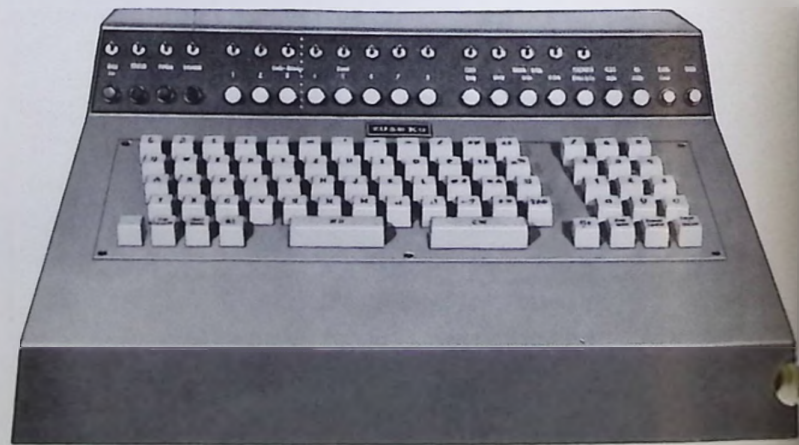
Tastatur der ZUSE Z 16, optische Betriebsanzeige, 68stellige frei belegbare Tastatur
